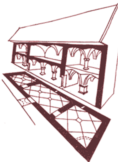
Рис. 5.2. Романский дом, план и разрез
