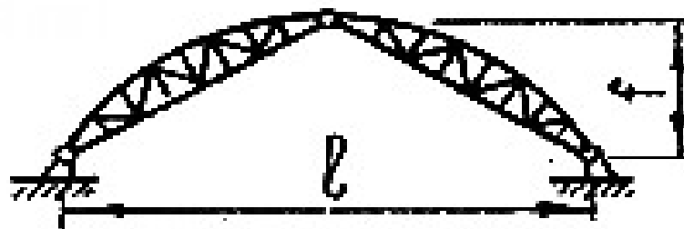
Рисунок 5 – Арка из фермы ( l=30...60 м, f=l/3...l/2 )
