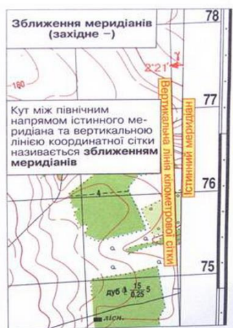
Рис. 3.4. Сближение истинного меридиана карты (восточная рамка) и осевого меридиана зоны (вертикальная линия километровой сетки)
