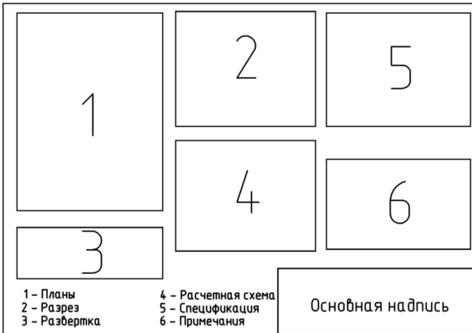
Рис. А. 14. Схема 2-го графического листа для ленточного фундамента мелкого заложения
